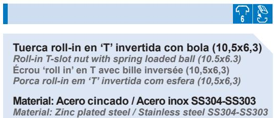
El modelo 'Roll-in' permite la inserción de la tuerca en el perfil en 'T' de manera vertical, mediante una sencilla rotación de la misma.
